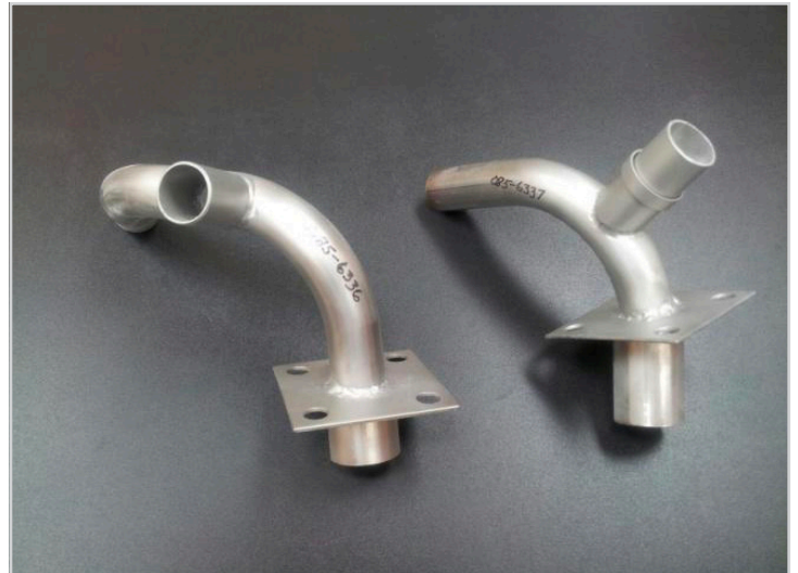
Inside Y Pipes Left 085-6336, Right 085-6337
